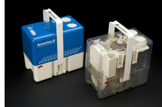
Generatori esausti di ^{99}\text{Mo}/^{99\text{m}}\text{Tc}
