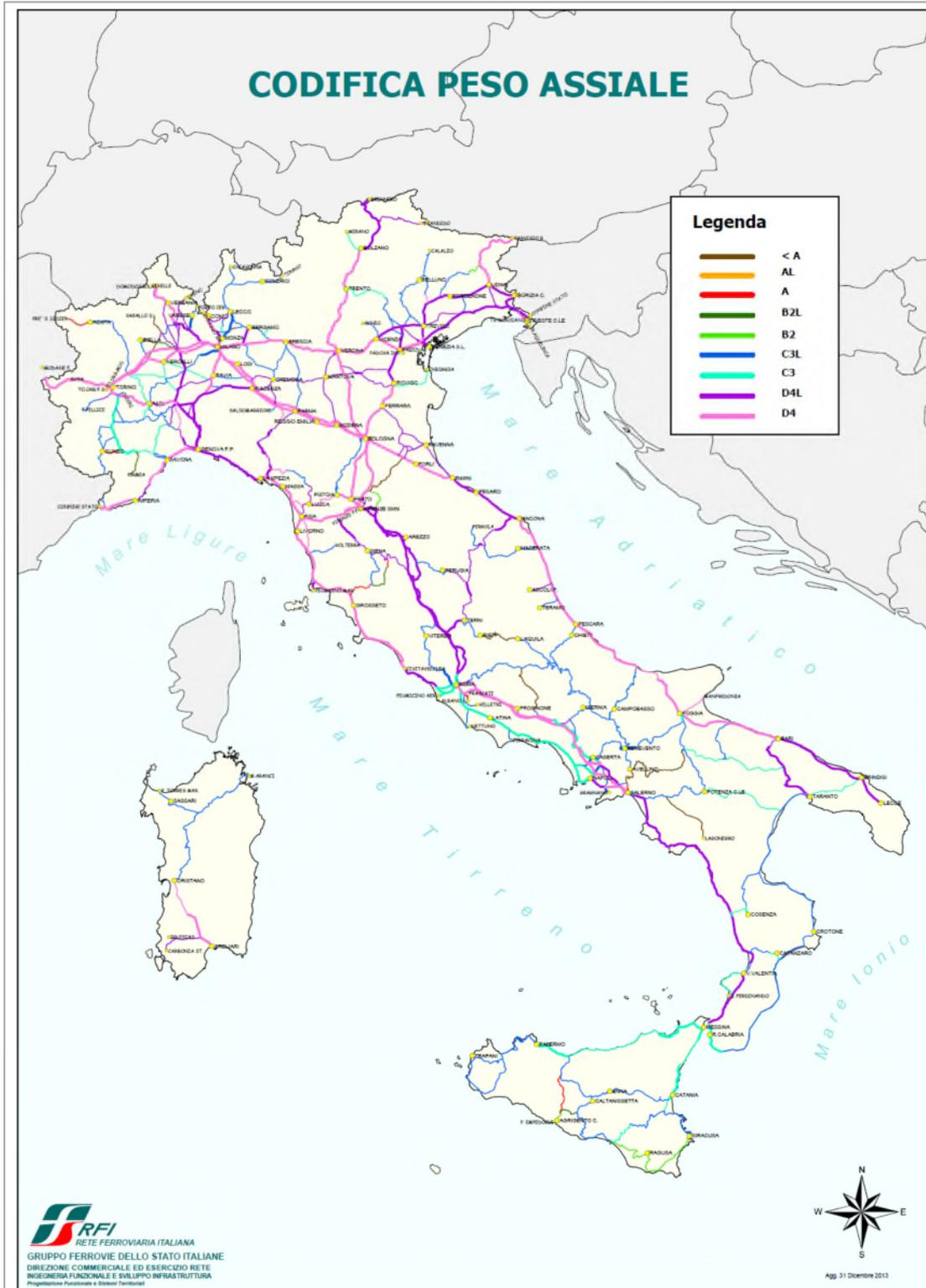
Figura 16.12/1 – Rete Ferroviaria Italiana distinta per “codifica peso assiale”; le linee idonee per il trasporto cask sono quelle con codice D4 e D4L.
