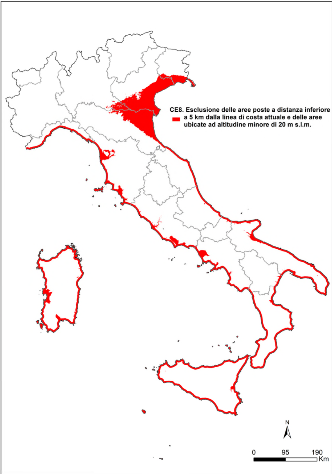
Figura 8/1 - Esclusione delle aree poste a distanza inferiore a 5 km dalla linea di costa attuale e delle aree ubicate ad altitudine minore di 20 m s.l.m. (CE8)
