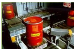
Acquisizione del codice dal fusto e controllo della dose a contatto
