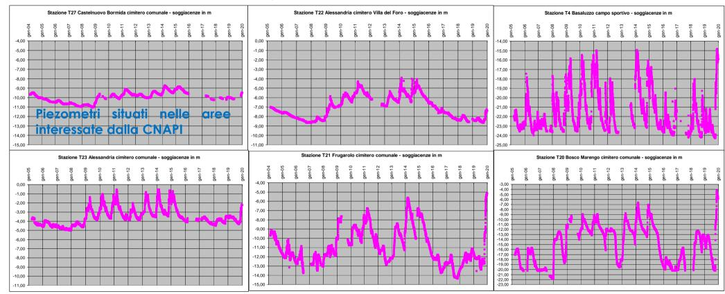
Non si è tenuto conto delle oscillazioni periodiche e stagionali della superficie piezometrica in relazione all'andamento climatico e ai prelievi. Per la zona AL 1 ad esempio sono registrare oscillazioni anche di 18m
