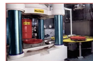
Infustamento in overpack per la cementazione
