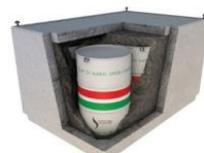
I manufatti vengono inseriti e cementati in moduli di calcestruzzo speciale (3m x 2m x 1,7m), progettati per resistere 350 anni
