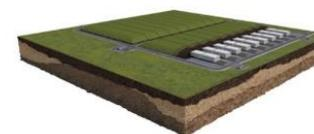
Struttura artificiale disposta a copertura delle celle. Viene realizzata con strati di diversi materiali allo scopo di impedire infiltrazioni di acque piovane, isolare i rifiuti dall'ambiente e migliorare l'impatto visivo della struttura.
