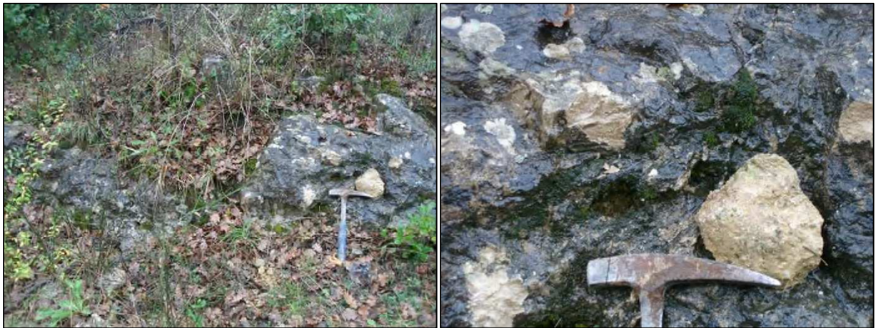
Figura 2.1.2 Affioramento di arenarie gialle in strati di spessore decimetrico e relativo dettaglio.
